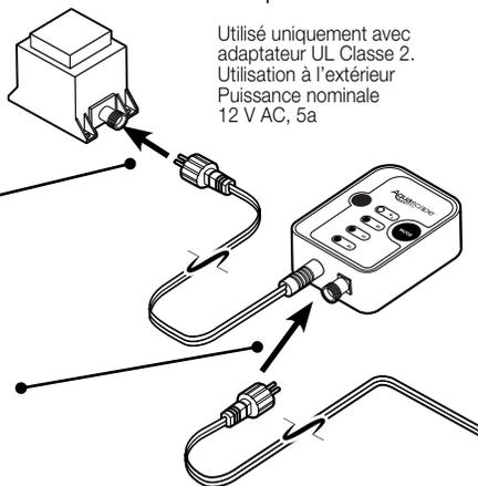
Utilisé uniquement avec adaptateur UL Classe 2. Utilisation à l'extérieur. Puissance nominale 12 V AC, 5a
