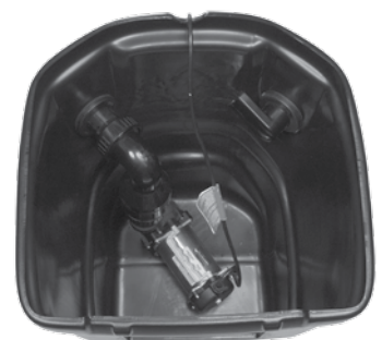
Ex. 15 Un adaptateur se visse directement dans la pompe et l'autre dans la cloison arrière de l'écumoire. Recouvrez le filetage du raccord de silicone ou de ruban de téflon (non fourni).
